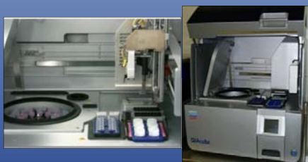
Figura 2. Equipo de extracción automática de DNA "QIACube" para analizar los posibles antagonistas a Fusarium verticillioides .
